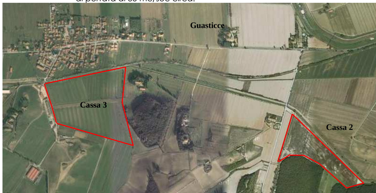
Figura 2 Casse in derivazione lungo il Fosso Acquasalsa
